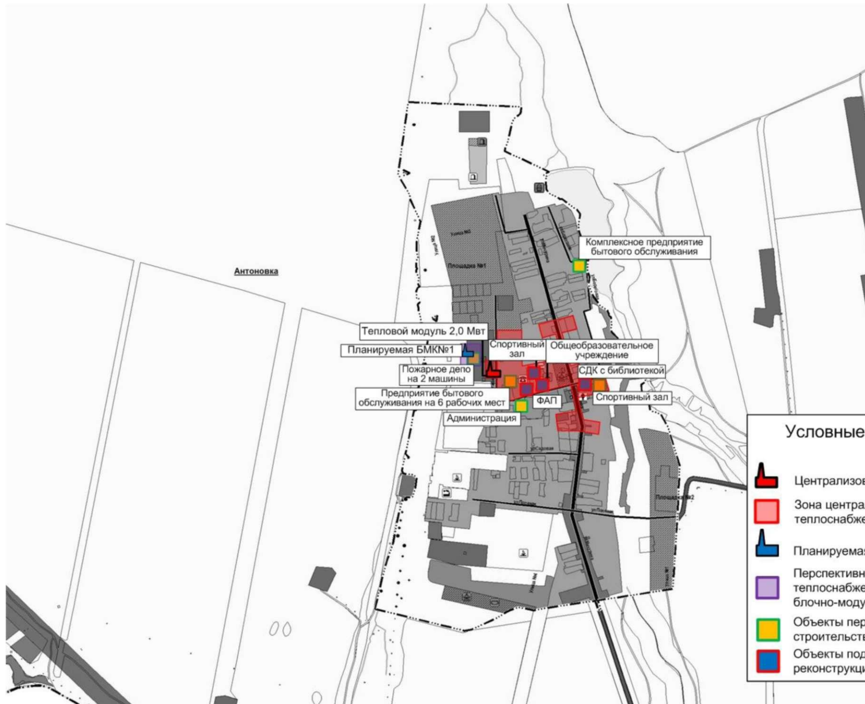
Рисунок 2.1.1 – Перспективные зоны теплоснабжения существующей котельной, а также планируемого блочно-модульного источника т
